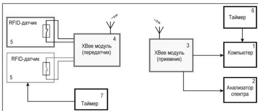
Рис. 4. Принципиальная схема установки сети устройств RFID: 1 – компьютер; 2 – анализатор спектра; 3 – XBee модуль (приемник); 4 – XBee модуль (передатчик); 5 – датчик RFID; 6, 7 – таймер
