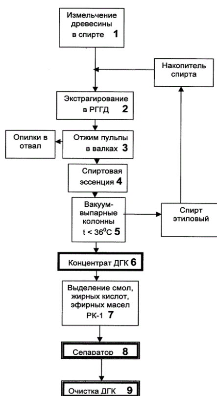
Рис. 2. Схема переработки древесины лиственницы по методу Бережной А.Г.
